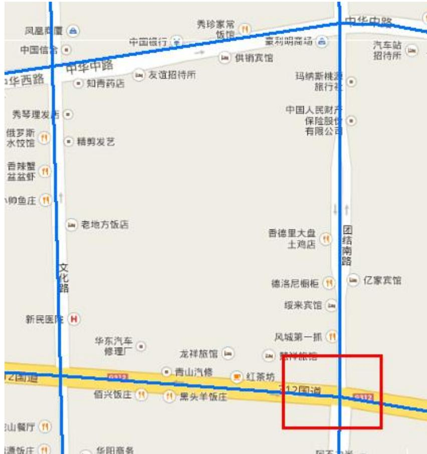
图中红框处就是校正后的显示效果。如果校正后，两者还未完全达到无缝的显示效果，可在上一次的基础上再次测量在线地图和矢量地图间的偏移值，在弹出后的对话框中勾选“与之前的偏移值累加”和“偏移值保存到配置文件”选项，单击“确定”按钮进行再次校正，直至叠加效果满意为止。
