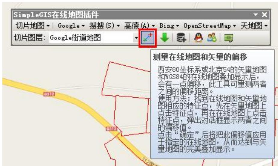
(3). 找出在线地图和 SHP 图层上的特征点，例如道路交叉点，下图中两个红框处（A 和 B 处）都是道路交叉点，应该两个位置在一起才正确。
