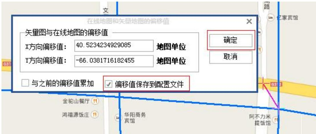
勾选对话框中的“偏移值保存到配置文件”选项，并单击“确定”后，系统会重新校正在线地图，使它与矢量地图达到如下显示效果：
